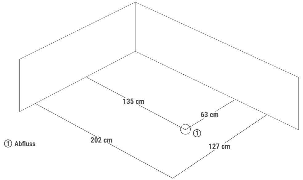
Bei dem gezeigten Anschlussplan handelt es sich um ein Beispiel, der Wasseranschluss kann flexibel hinter der Wanne platziert werden (maximale Höhe 35 cm).
